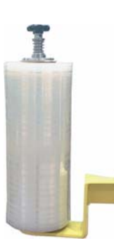
Kernbremsung einfaches Prinzip der Foliendehnung
